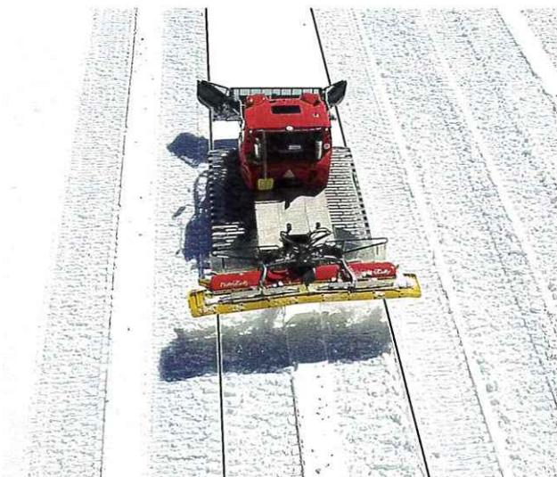
Im Schnee wie auf dem Acker: Wird die Geräteüberlappung reduziert, steigt die Arbeitsleistung.
