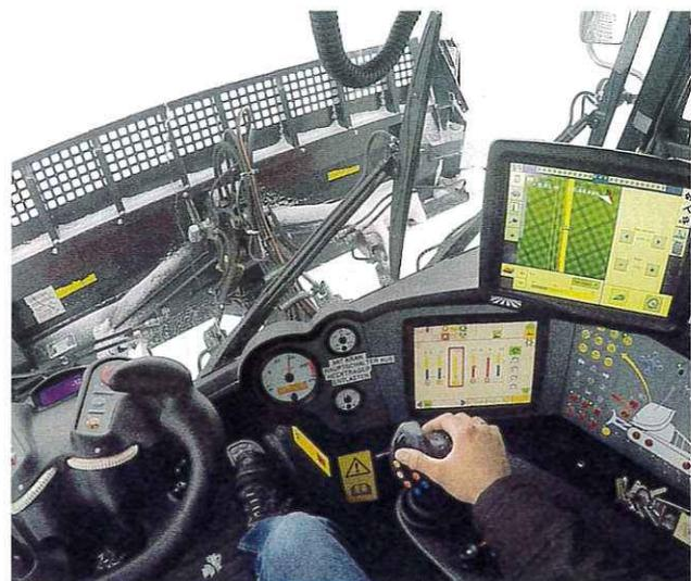
Die automatische Lenkung entlastet den Fahrer. Er kann sich besser auf die Bearbeitung der Piste konzentrieren.
