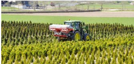
Der Düngerstreuer kann für höhere Kulturen dank Hubmast angehoben werden.
