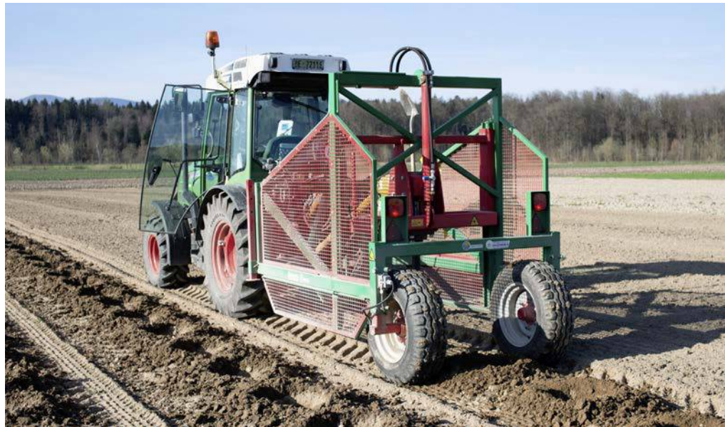
Die elektronische Steuerung des Erdlochbohrers steuert den Traktor automatisch von einem Bohrloch zum nächsten.
